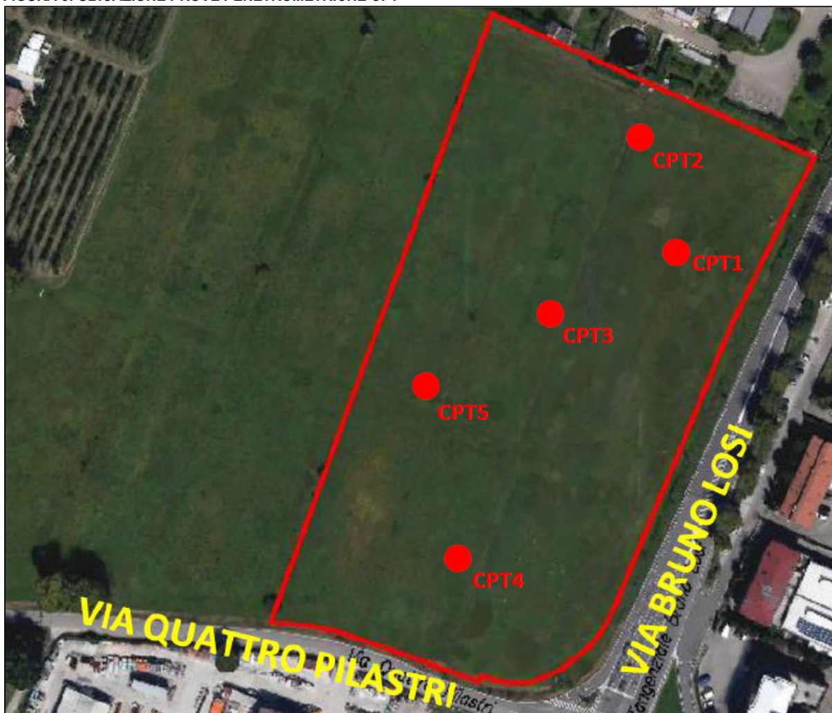
FIGURA 3: UBICAZIONE PROVE PENETROMETRICHE CPT
