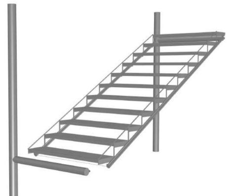
Modello tridimensionale della rampa tipo e dettaglio sul sistema antipánico dei gradini
