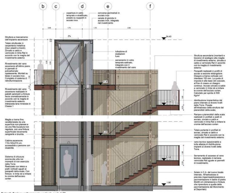
Dettagli: Sezione collegamento verticale scala 1:50
