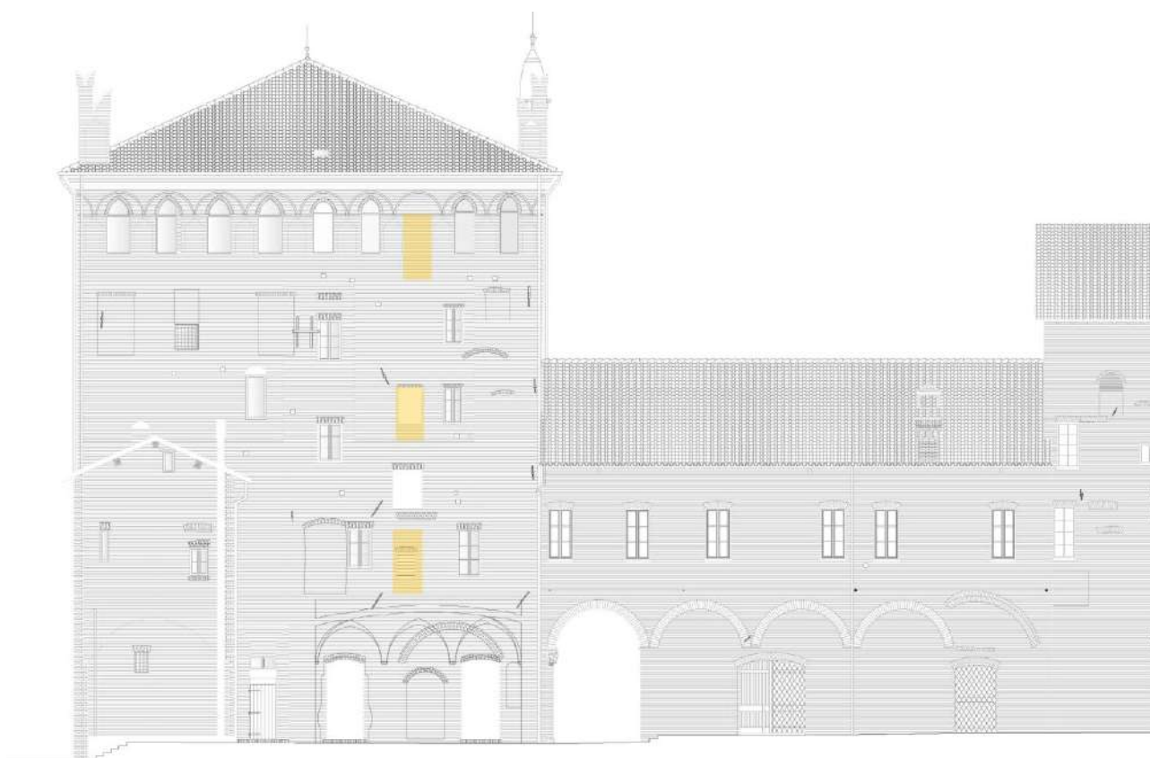
Indicazioni relative alla realizzazione delle nuove aperture nel Torrione degli Spagnoli (prospetto est)
