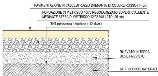
Figura 3-5: Dettaglio pavimentazione ciclabile in calcestruzzo drenante
